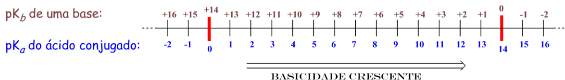
Figura 2.10.6. Relação entre pK b de uma base e pK a de seu ácido conjugado
